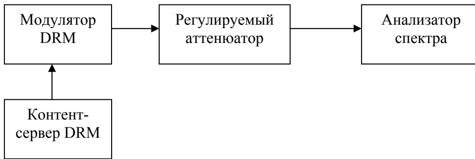
Рисунок 6 - Схема измерения ширины полосы частот внеполосных радиоколесаний и относительного уровня побочных радиоколесания модулятора
