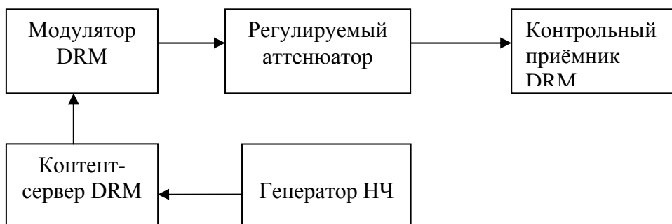
Рисунок 7 - Схема проверки алгоритмов кодирования аудиосигнала контент-сервером
